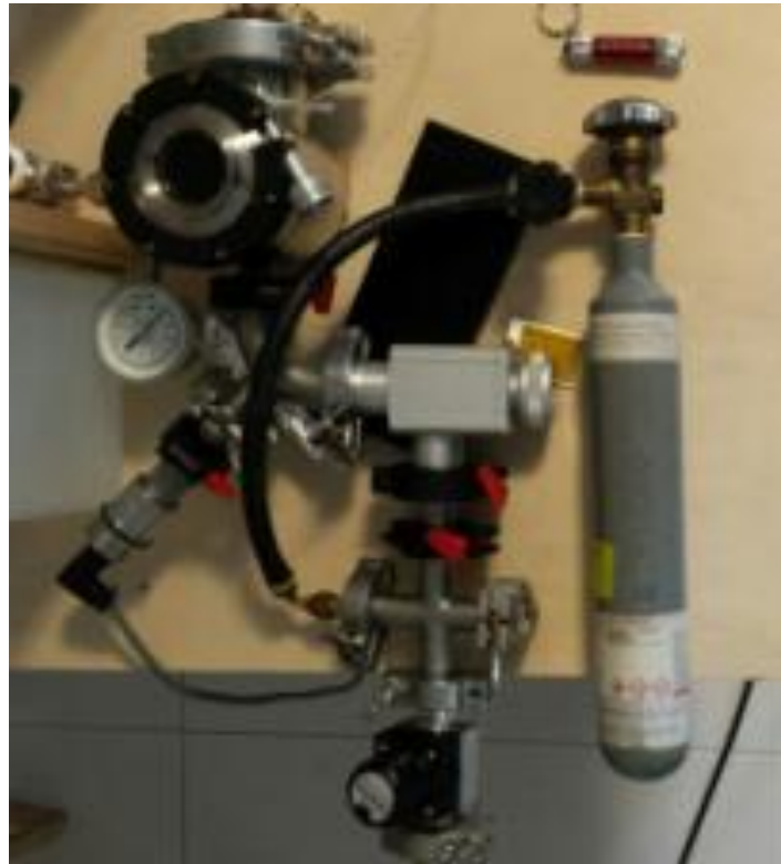
Deuterium loading setup
